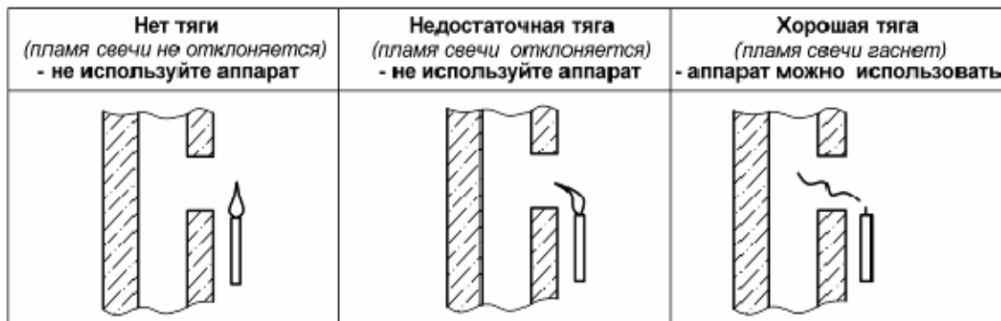
Рисунок 3. Способ проверки тяги в дымоходе
